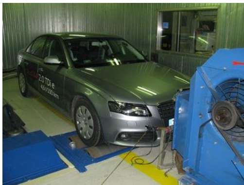
14. ábra: A KTI görgős járművizsgáló laborja
